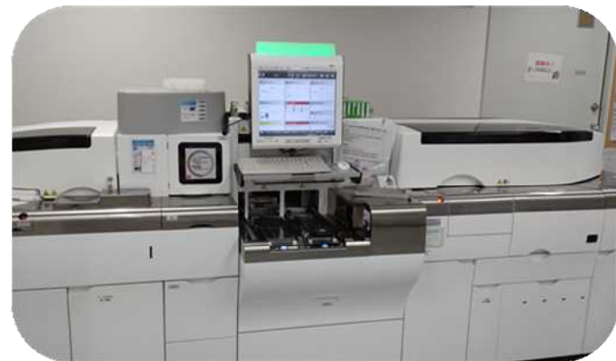
生化学検査・免疫検査やコロナ抗原定量検査なども行うことができる連結自動分析装置
